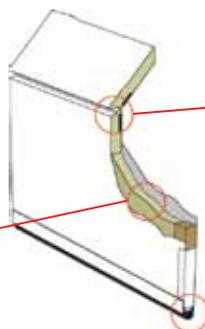
Coupe-froid et joint horizontal procurant une étanchéité parfaite. Aucune circulation d'air entre les panneaux.
